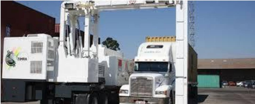
*Figura 1 Inspección no intrusiva usando scanner NII*
