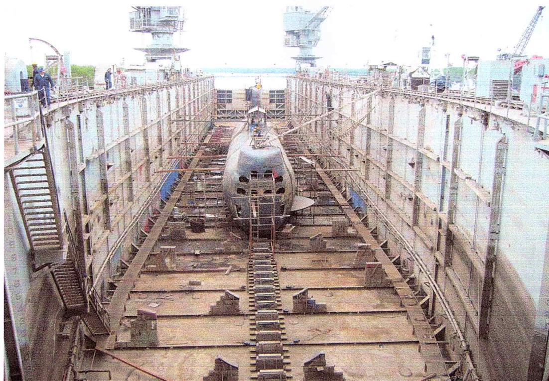
Fotografía No.2.- Dique flotante, ejecutando trabajos de carenamiento y mantenimiento de un submarino de la Armada Nacional.
