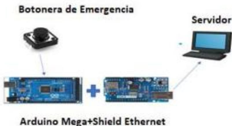
Figura 5: Diagrama de la conexión de la botonera
