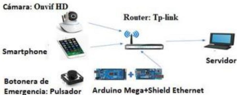
Figura 6: Esquema simplificado de la estación remota
