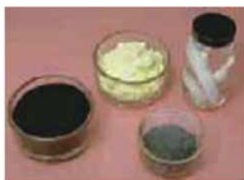
▲ Figura 7.16 Los no metales tienen muy diversos aspectos. Aquí se muestran (en sentido horario desde la izquierda) carbono como grafito, azufre, fósforo blanco (guardado bajo agua) y yodo.
