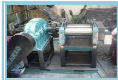
Tercero: Pesar los químicos que se utilizarán en el proceso de fabricación, se mezcla poco a poco en el molino hasta obtener el caucho, el mismo que sale en tiras largas, de allí se lo empapa de carbonato para obtener un guardapolvo bien suave para posteriormente llevarlo a las vulcanizadoras.
