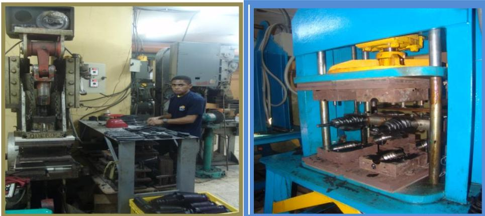
Quinto: Para la elaboración del repuesto se corta y pesa 180 gramos de caucho molido y se aplica a la prensa, se cierra y se controla por reloj 2 minutos para que esté listo.
